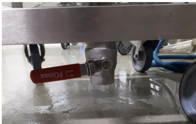
Vidanger le bac avec la vanne de vidange
