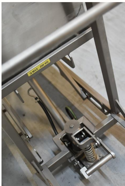
Montée via le système de pédale
